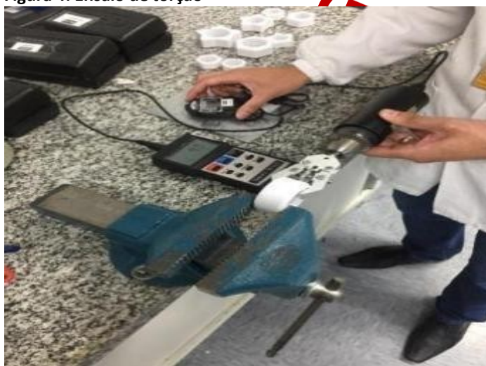
Figura 4: Ensaio de torção
