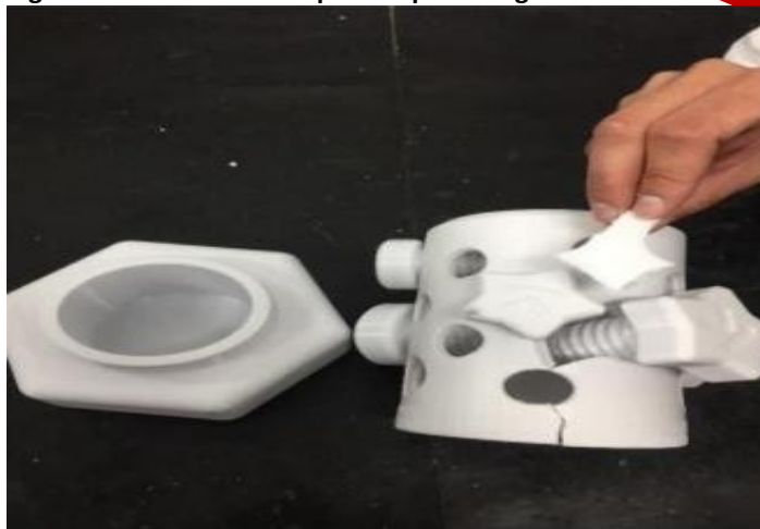
Figuras 7: Fratura no brinquedo e pontas agudas
