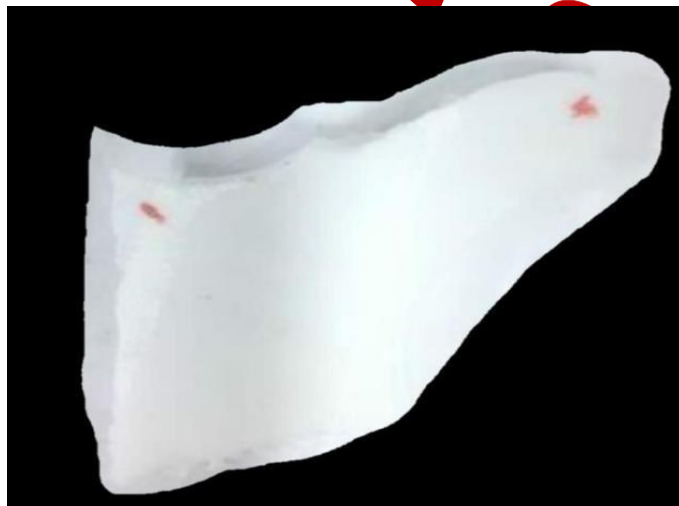
Figura 8: Fratura no brinquedo e pontas agudas
