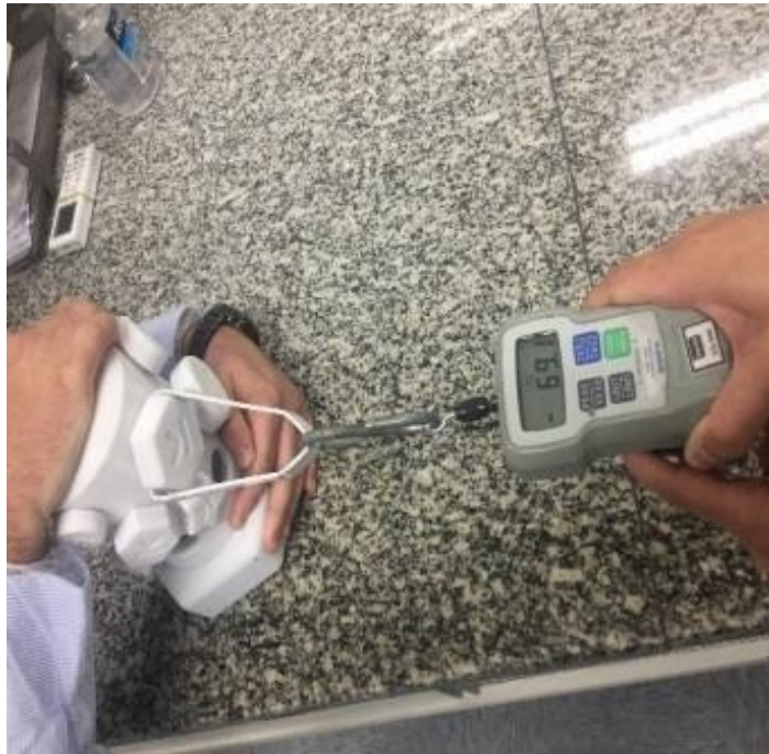
Figura 5: Ensaio de tração
